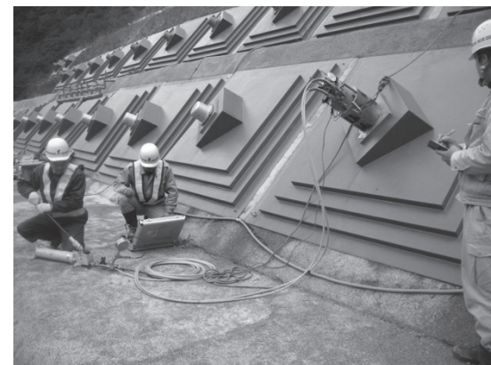
図-02 SAAM システムによる試験状況
