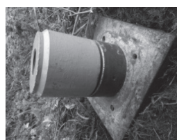
(d) SAAM ジャッキ設置
