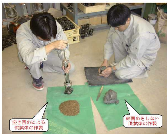
安定処理土の供試体作成
